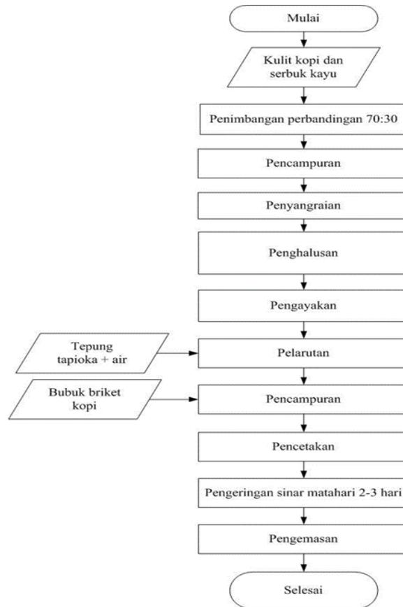
Gambar 1. Diagram Alir Pembuatan Briket Kulit Kopi
