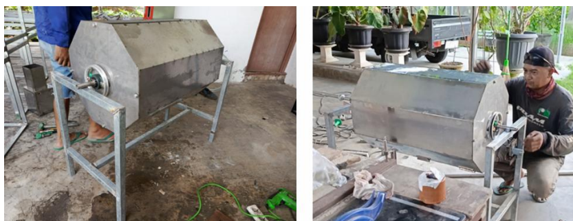
Gambar 4. Pembuatan tabung mesing pengering keripik kentang putih Sumber: Penulis (2025)
